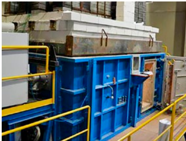
↑ De 2resist® is uiterst positief getest in de oven van Efectis in Bleiswijk.
