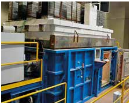
↑ De 2resist® is uiterst positief getest in de oven van Efectis in Bleiswijk.
